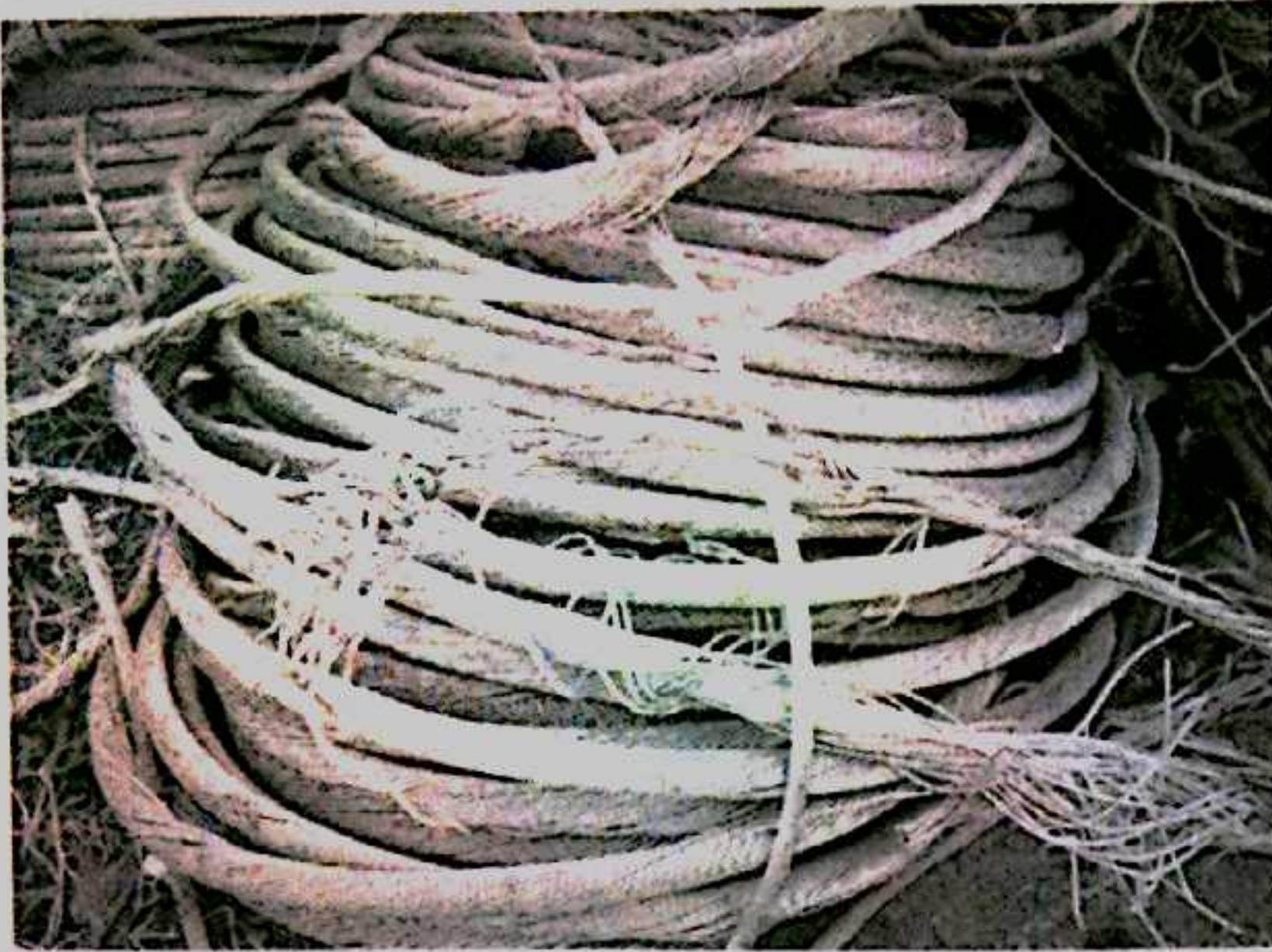
ヤードに置かれた鋼心アルミより線
